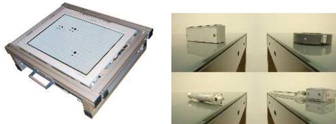
MightyTrace: Prototyp einer neuen Trackingtechnologie auf LCD, rechts die bestehenden Interaktionsgeräte.
